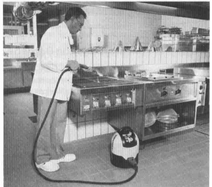
Dampfstrahlreinigung in einer Großküche
